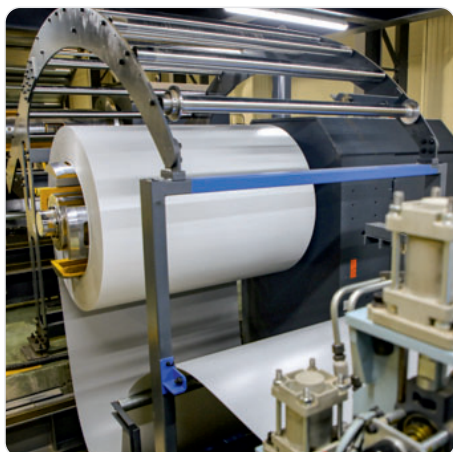
БЛОК РАЗМОТКИ МЕТАЛЛА Spread the roll
