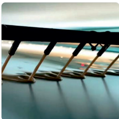
БЛОК ДОЗИРОВАНИЯ КОМПОНЕНТОВ ПИР PIR components dosing line
