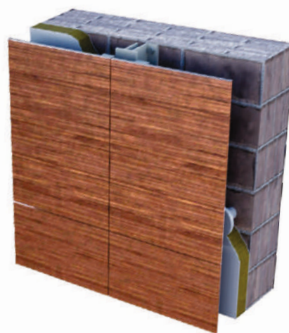
Способ подвесной установки / Hanging installation method
