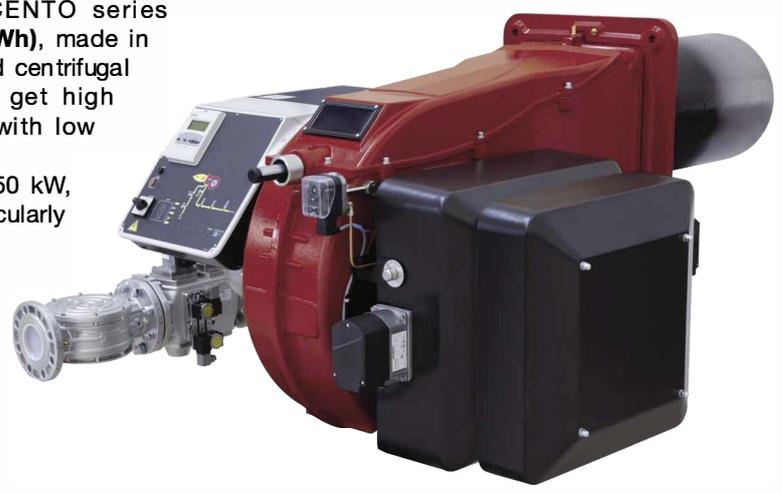
Новые горелки серии Standard H с низким выбросом окиси азота, класса 2 (< 120 мг/кВтч), выполненные в алюминиевом корпусе с загнутым назад центробежным рабочим колесом, изучены и разработаны для обеспечения высокой производительности и КПД в сочетании с низким уровнем выбросов. Горелки этой серии, максимальная мощность которых составляет 6850 кВт, отличаются особой конкурентоспособностью в данной линейке. Удобство в эксплуатации и обслуживании - сильные стороны этих горелок.
